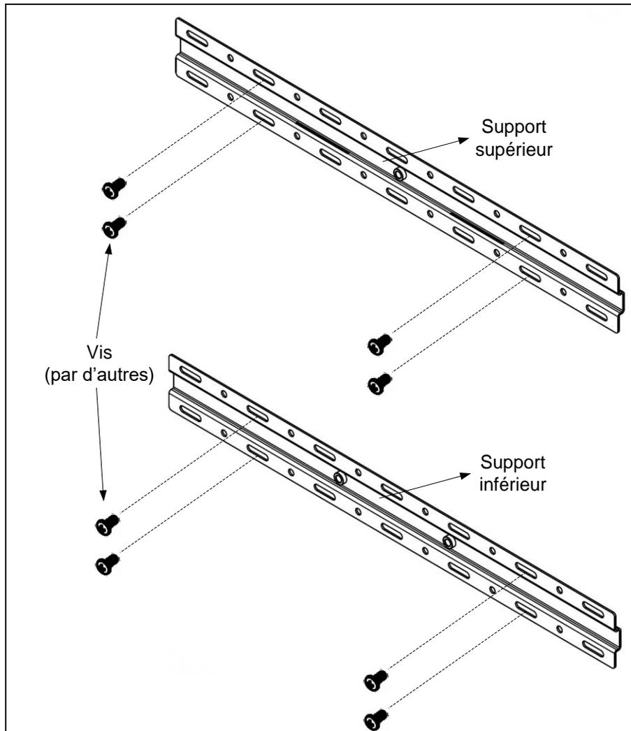
Illustration 10 - Fixation des supports de montage
