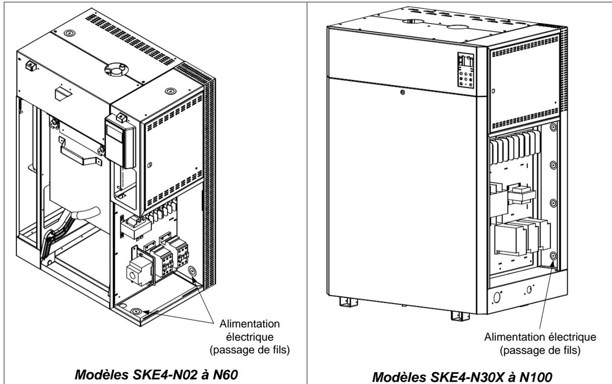
Illustration 43 - Trous pour alimentation électrique (humidificateur standard)
