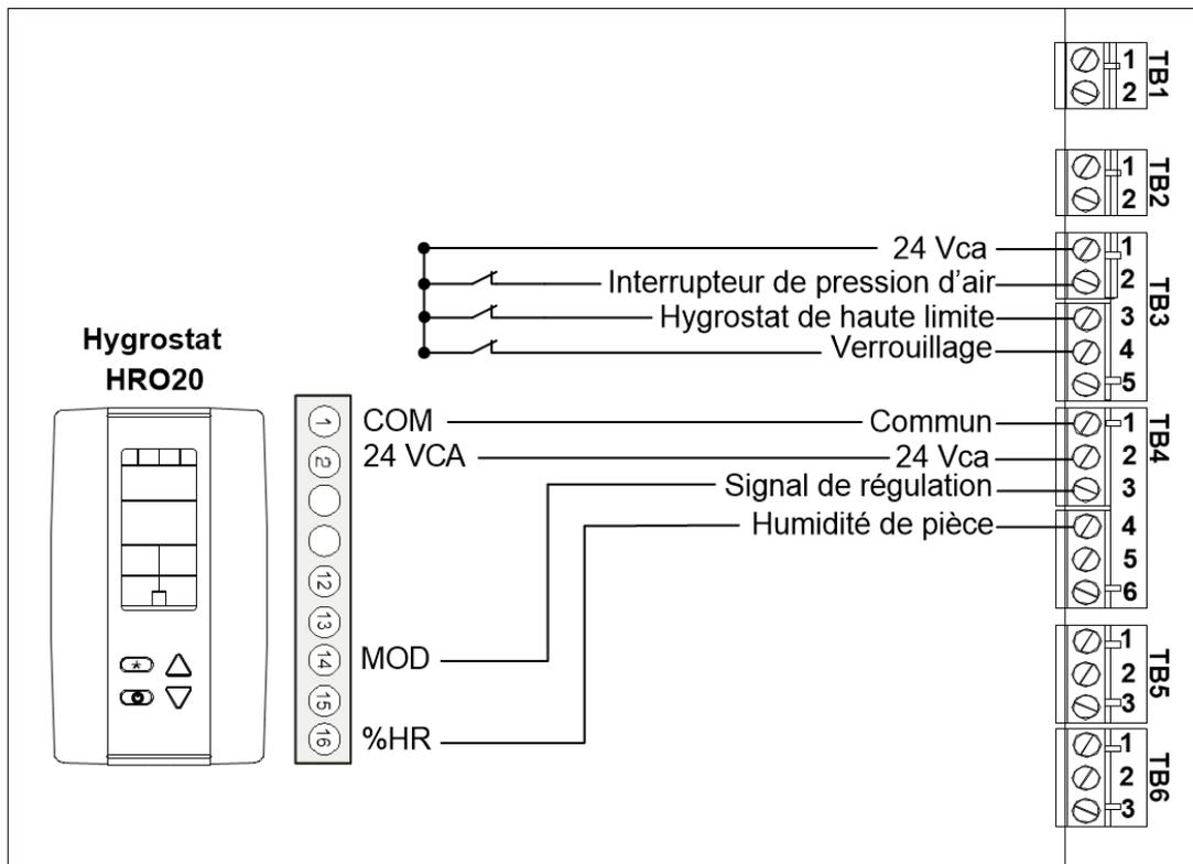
Illustration 49 - Signal de contrôle d'un hygromètre HRO20
