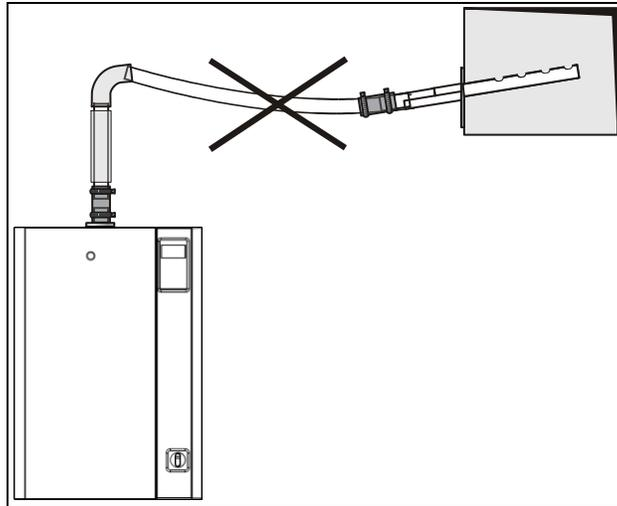
Illustration 31 - Installation erronée de la sortie de vapeur
