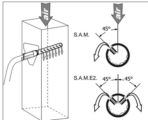
Illustration 22 - Distributeur S.A.M. ou S.A.M.E2 dans conduit vertical
