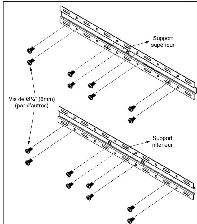
Illustration 14 - Fixation des supports de montage OSHPD
