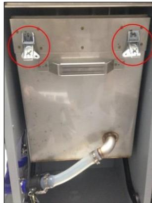
3. Une fois que l'eau supplémentaire a cessé de s'écouler dans la chambre d'évaporation, verrouillez les loquets pour reconnecter la chambre d'évaporation.
