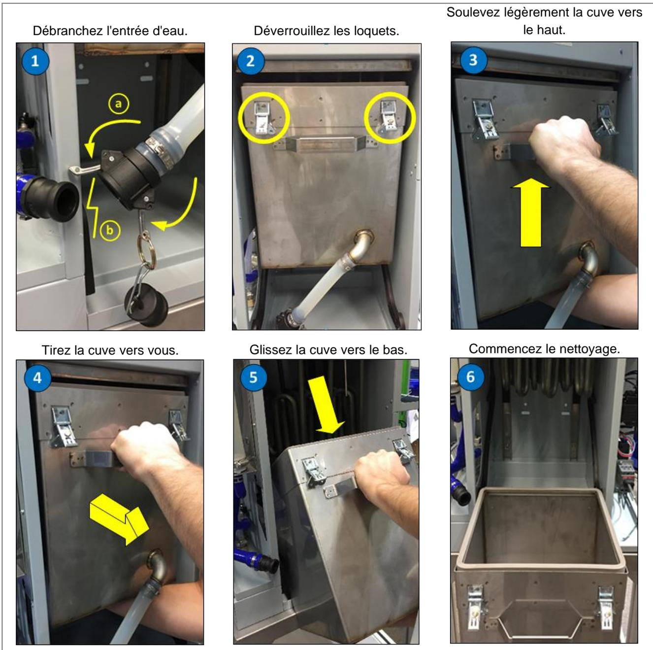
1. Avec la porte d'accès avant enlevée, débranchez l'entrée d'eau fixée à l'avant de la chambre d'évaporation, en retirant les goupilles de sécurité et en déconnectant manuellement le raccordement du tuyau d'entrée d'eau de la section de plomberie de l'humidificateur. Connectez et fixez le bouchon d'eau à l'entrée, afin d'empêcher l'eau de s'échapper de la chambre d'évaporation.
