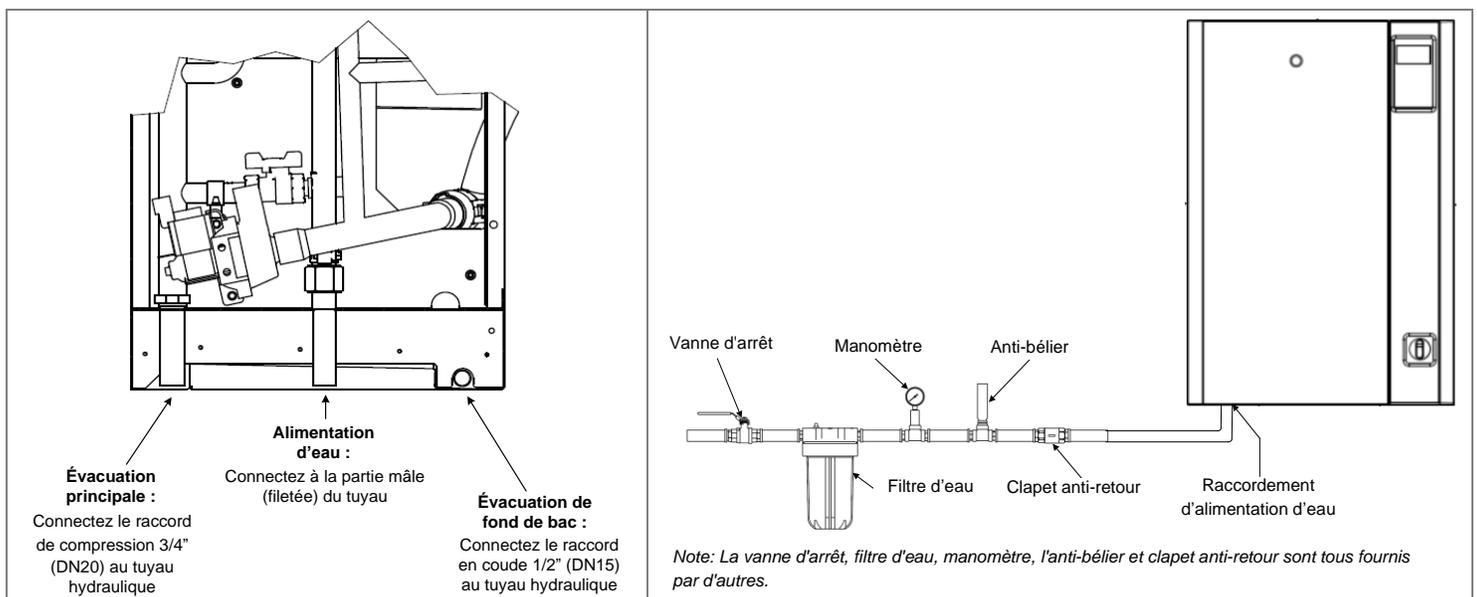
Illustration 38 - Raccordement d'alimentation et d'évacuation d'eau
