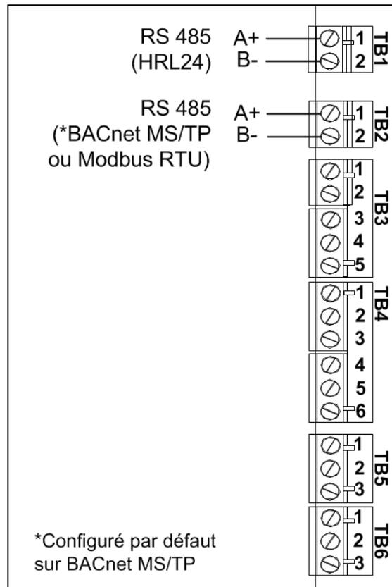
Illustration 53 - Connexions au réseau de communication
