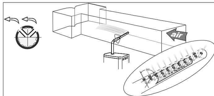
Illustration 21 - Distributeur S.A.M.E2 dans conduit horizontal
